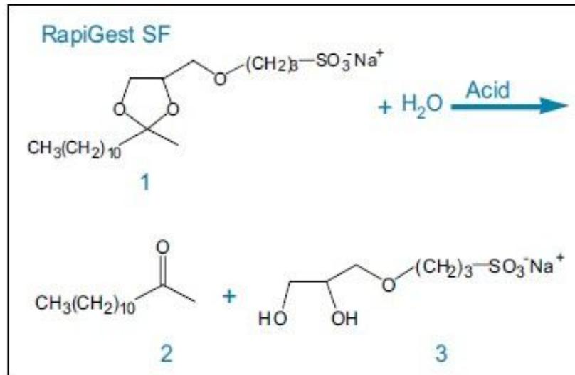
图2 RapiGest SF (1)在酸性溶液中降解为(2)和(3), 在pH 2为2时,  $t_{1/2}$ 为7.6分钟
